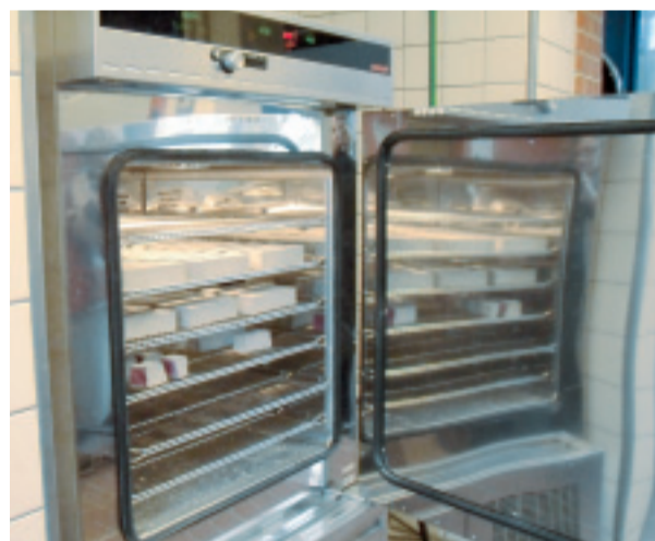
Baustoff-Prüfkörper im Memmert Klimaprüfschrank CTC Building material test samples in a Memmert climatic test chamber CTC
