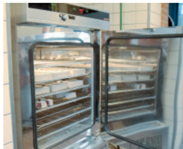
Des échantillons de matériaux de construction dans l'enceinte d'essais climatiques CTC de Memmert Especímenes de materiales de construcción en la cámara para pruebas climáticas CTC de Memmert
