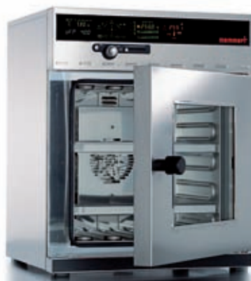
LEONI contrôle ses câbles et conducteurs dans l'étuve Memmert UFP 400
