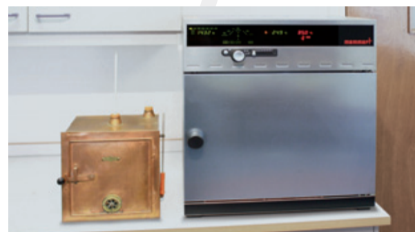
Incubateur original de Lennox avec jaquette d'eau (vers 1925), aux côtés d'un appareil Memmert moderne
