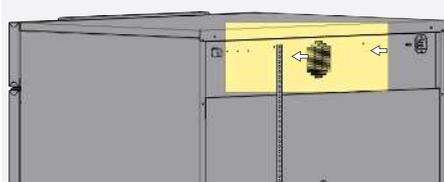
1. Visser le dispositif antibasculement à l'arrière de l'appareil, comme indiqué sur l'illustration.
