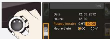
4. À l'aide du bouton rotatif, régler le fuseau horaire en fonction de la localisation de l'appareil (par ex. 00:00 pour le Royaume-Uni, 01:00 pour la France, l'Espagne ou l'Allemagne).
