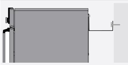
2. Plier le dispositif antibasculement vers le haut à la distance souhaitée pour former un angle à 90° avec le mur (veiller à laisser un écart minimum avec le mur).
