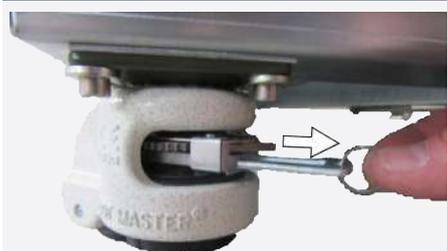
1. Pour déverrouiller le mécanisme de réglage, tirer sur le levier à cliquet de la bague.
