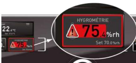
Dès que le dispositif de sécurité hygrométrique est déclenché, cet événement est signalé dans l'affichage de l'humidité par l'humidité effective indiquée en rouge et par un symbole d'alarme ▲.
