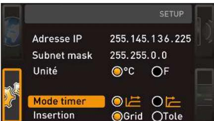
Il est possible de définir si l'horloge numérique avec définition de la durée cible (voir ▶6.5.2 Horloge numérique) doit fonctionner en fonction de la valeur de consigne ou indépendamment, c'est-à-dire si le cycle de programmation doit démarrer uniquement lorsqu'une bande de tolérance correspondante dépendant de la température de consigne est atteinte (Ⓢ) ou immédiatement après l'activation de la minuterie (ⓐ).
