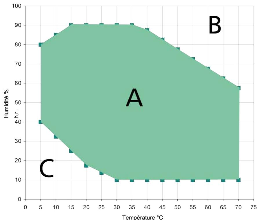
**A** Dans cette plage, la température et l'humidité sont combinées au choix sans qu'un niveau important de condensation se forme. Il est possible de restreindre la plage de fonctionnement lorsque les conditions d'environnement sont extrêmes.
