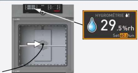
8. Mettre la sonde de l'instrument de mesure étalon au milieu du caisson intérieur de l'appareil.
