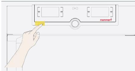
1. Appuyez sur l'interrupteur principal de l'appareil.
