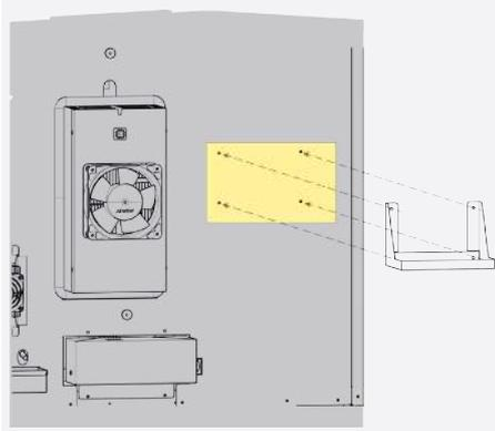
1. Fixer le support de bidon à la paroi arrière à l'aide de quatre vis.
