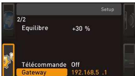
L'entrée de configuration Passerelle sert à relier deux réseaux avec des protocoles différents. La passerelle est configurée de la même manière que l'adresse IP (voir ►8.3.2 Adresse IP et masque de sous-réseau).
