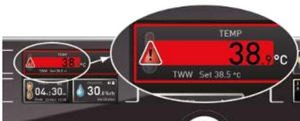
Wenn eine Temperaturüberwachung angesprochen hat, wird dies in der Temperaturanzeige angezeigt: durch die rot hinterlegte Ist-Temperatur und ein Alarmsymbol ▲. Darunter wird angezeigt, welche Art Temperaturüberwachung angesprochen hat (siehe ▶7 Störungen, Warn- und Fehlermeldungen).
