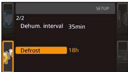
Die integrierte Abtauautomatik für das Kühlaggregat sorgt bei tiefen Temperaturen auch im Dauerbetrieb für eine einwandfreie Funktion des Kühlbrutschranks. Das Abtauintervall kann in 6-Stunden-Schritten zwischen 6 und 48 Stunden eingestellt werden. Die Einstellung **Off** deaktiviert die Abtauautomatik.
