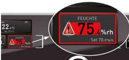
Wenn die Feuchteüberwachung angesprochen hat, wird dies in der Feuchteanzeige angezeigt: durch die rot hinterlegte Ist-Feuchte und ein Alarmsymbol ▲.
