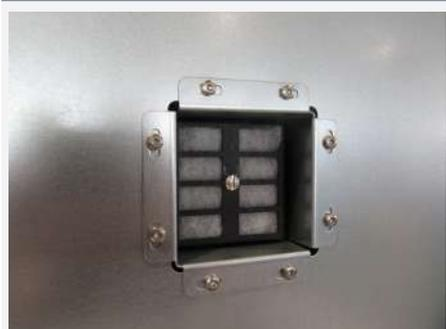
1. Lösen Sie die Schraube mit einem Schlitzschraubendreher
