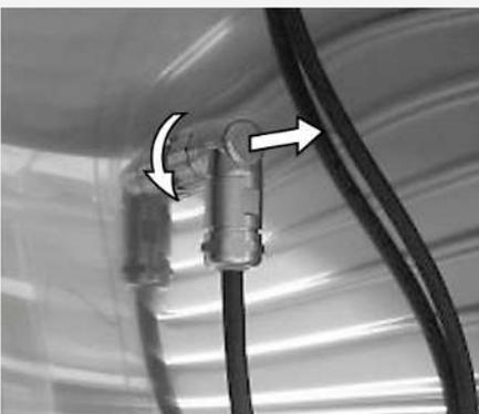
3. Lösen Sie den Anschlussstecker der Lichtkassette im Innenraum und drehen Sie gleichzeitig den Bajonettverschluss nach links.
