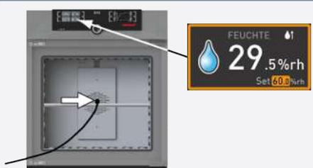
8. Platzieren Sie den Sensor des kalibrierten Referenzmessgeräts in der Innenraummitte des Geräts.
