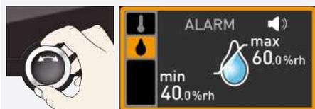
2. Drehen Sie den Drehknopf, bis die Feuchteinstellung markiert ist.
