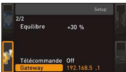
L'entrée de configuration Passerelle sert à relier deux réseaux avec des protocoles différents. La passerelle est configurée de la même manière que l'adresse IP (voir ►8.3.2 Adresse IP et masque de sous-réseau).
