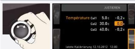
5. Régler la valeur corrective d'étalonnage sur 0,0 K.
