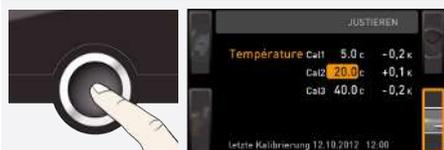
2. Appuyer sur la touche de validation jusqu'à ce que la température d'étalonnage Cal2 soit sélectionnée.
