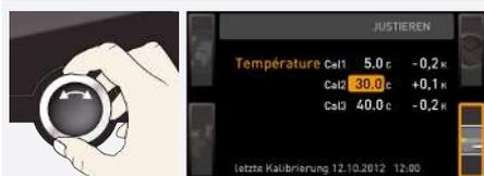
3. À l'aide du bouton rotatif, régler la température d'étalonnage Cal2 sur la température indiquée.
