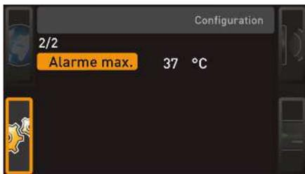
C'est ici que l'on paramètre la température de déclenchement du dispositif de sécurité thermique automatique.
