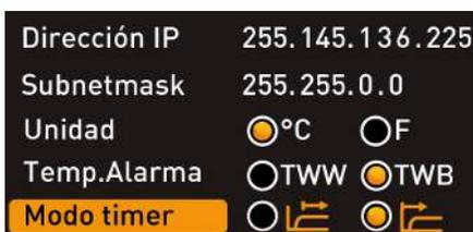
Aquí se puede ajustar si el reloj digital marcha atrás con indicación de la hora objetivo (véase ▶6.5.2 Reloj digital marcha atrás) debe funcionar o no en función del valor de consigna, es decir, si el tiempo de funcionamiento del temporizador debe iniciarse solo cuando se alcance la correspondiente banda de tolerancia en torno a la temperatura de consigna ⑥ o inmediatamente después de que se active el temporizador ⑦.
