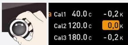
5. Ajuste el valor de corrección de ajuste a 0,0 K.
