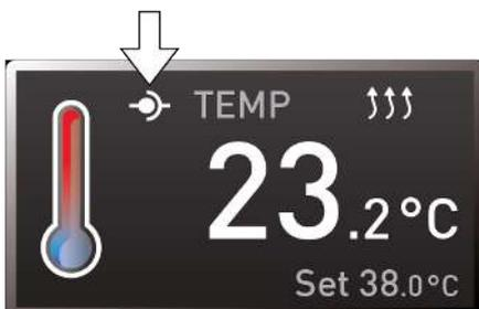
Quando el equipo está en modo control remoto, esto se reconoce mediante el símbolo en la indicación de temperatura. En los ajustes **Escritura + lectura** y **Escritura + alarma**, el equipo ya no se puede manejar en el ControlCOCKPIT hasta que el control remoto se apague de nuevo (ajuste **Off**) o se cambie a Lectura.
