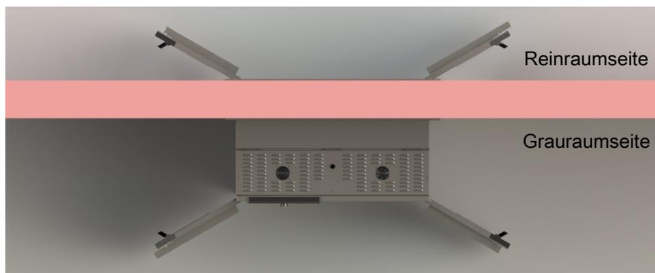
Asegúrese de que la salida de aire se encuentra en el lado de la sala gris y la abertura para el aire de entrada, en el lado de la sala blanca. El ControlCOCKPIT debe estar siempre en el lado de la sala gris.
