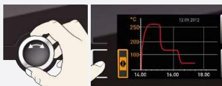
2. Pulse el botón de activación situado junto a los símbolos de flecha ◀▶ para cambiar el intervalo de tiempo de visualización.
