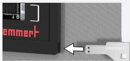
1. Inserte el dispositivo de memoria USB con los datos de USER-ID en el puerto situado en el lado derecho del ControlCOCKPIT.
