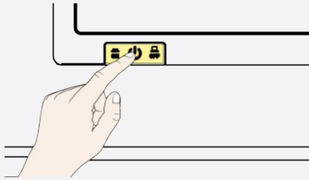
1. Encienda el equipo pulsando el interruptor principal situado en la parte delantera del equipo.
