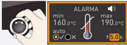
8. Utilice el botón giratorio para ajustar la banda de tolerancia deseada.
