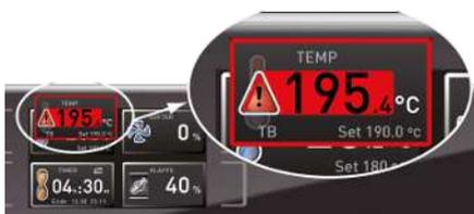
Si se ha activado una supervisión de temperatura, esto se informa a través de la indicación de la temperatura: mediante la temperatura real resaltada en rojo y un símbolo de alarma . Debajo se muestra qué tipo de supervisión de temperatura se ha activado (véase ▶7 Averías, mensajes de advertencia y error).
