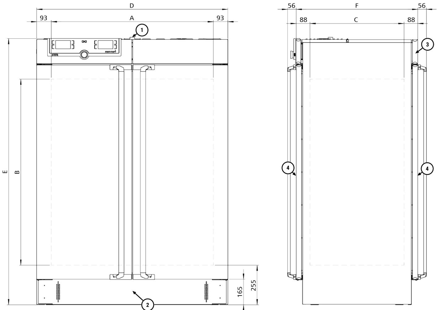
1 Salida de aire  $d = 30 \text{ mm}$
