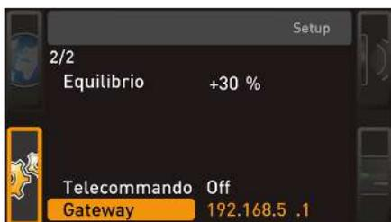
La entrada de Setup Gateway se utiliza para conectar dos redes con protocolos diferentes. La puerta de enlace (gateway) se ajusta de la misma manera que la dirección IP (véase ▶8.3.2 Dirección IP y máscara de subred).
