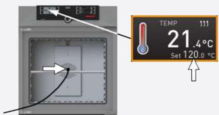
7. Coloque el sensor de un medidor de referencia calibrado en el centro del interior del equipo.
