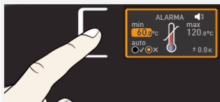
1. Pulse el botón de activación situado a la izquierda de la indicación **ALARM**.
