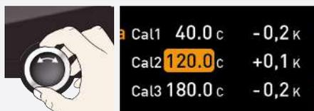
3. Ajuste la temperatura de referencia Cal2 a la temperatura especificada mediante el botón giratorio.
