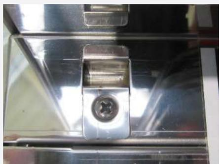
1. Suelte el tornillo en cruz del soporte del perno de cierre en el bastidor transversal inferior con un destornillador.
