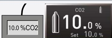
14. Haga coincidir el valor de CO<sub>2</sub> medido del medidor de referencia con el valor de salida de CO<sub>2</sub> del equipo.
