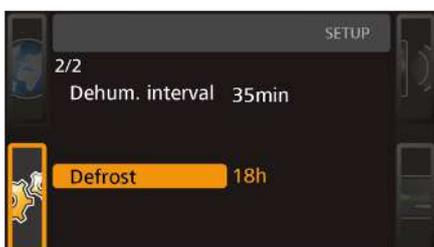
El sistema automático de descongelación integrado de la unidad de refrigeración garantiza que el incubador refrigerado funcione perfectamente incluso en funcionamiento continuo a bajas temperaturas. El intervalo de descongelación puede ajustarse en incrementos de 6 horas, entre 6 y 48 horas. El ajuste **Off** desactiva el sistema automático de descongelación.
