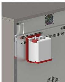
En el caso de los equipos de tamaño 750, el depósito de agua puede fijarse al equipo mediante el soporte para bidón suministrado. Para ello, enganche el soporte para bidón en las ranuras de la parte posterior del equipo. El soporte para bidón también cuenta con dos orificios a través de los cuales se puede fijar a la pared (material de fijación no incluido en el volumen de suministro).
