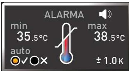
La temperatura de supervisión de la supervisión electrónica de la temperatura se mide mediante un sensor de temperatura Pt100 independiente situado en el interior. Los ajustes de supervisión de la temperatura se realizan en la indicación **ALARMA**. Los ajustes realizados son efectivos en todos los modos de funcionamiento.
