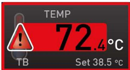
El equipo dispone de un limitador mecánico de la temperatura (TB) clase de protección 1 según DIN 12880.
