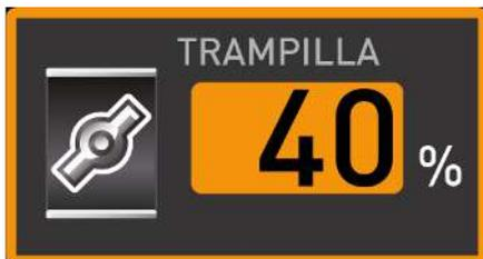
Rango de ajuste: 0 % (cerrada, modo recirculación) hasta 100 % (totalmente abierta, modo aire fresco) en pasos de 10 %.
