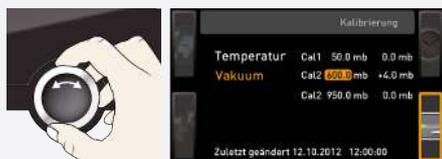
5. Ajuste el punto de referencia **Cal2** a 600 mbar mediante el botón giratorio.
