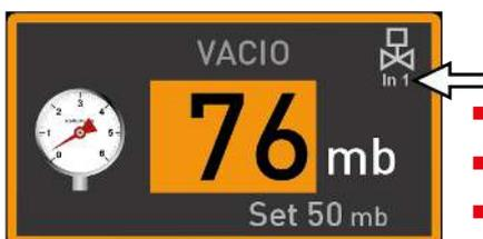
La indicación In1/In2 en la esquina superior derecha (flecha, solo para Premium V049 y 101) indica qué conexión de gas está activa en ese momento:
