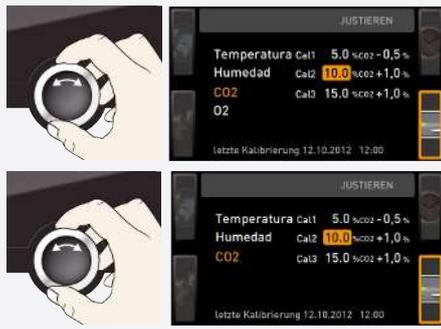
4. Ajuste el punto de referencia Cal2 a 10 % mediante el botón giratorio.
