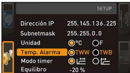
Aquí puede ajustar qué tipo de clase de protección térmica según DIN 12 880:2007-5 (TWW o TWB) se va a utilizar (descripción en ▶6.6 Función de supervisión).
