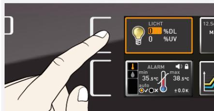
1. Active la indicación de iluminación pulsando el botón de activación situado a la izquierda de la indicación de iluminación.
