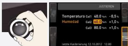
4. Ajuste el punto de referencia Cal2 a 60 % hr mediante el botón giratorio.
