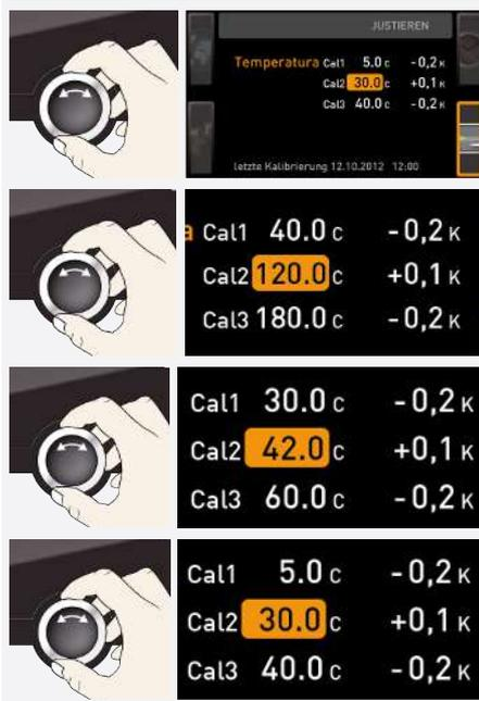
3. Ajuste la temperatura de referencia Cal2 a la temperatura especificada mediante el botón giratorio.
