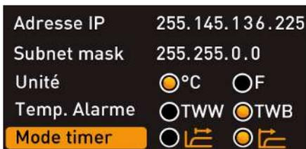
Il est possible de définir si l'horloge numérique avec définition de la durée cible (voir ►6.5.2 Horloge numérique) doit fonctionner en fonction de la valeur de consigne ou indépendamment, c'est-à-dire si le cycle de programmation doit démarrer uniquement lorsqu'une bande de tolérance correspondante dépendant de la température de consigne est atteinte  $\text{ⓐ}$  ou immédiatement après l'activation de la minuterie  $\text{ⓐ}$ .
