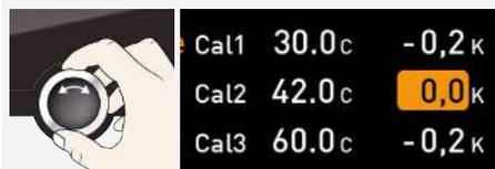
5. Régler la valeur corrective d'étalonnage sur 0,0 K.
