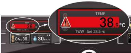
Dès que le dispositif de sécurité thermique est déclenché, cet événement est signalé dans l'affichage de la température par la température effective indiquée en rouge et par un symbole d'alarme ▲. Le dispositif de sécurité thermique responsable du déclenchement apparaît en dessous (voir ▶7 Dysfonctionnements, messages d'avertissement et d'erreur).
