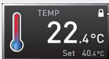
Cette action peut en outre verrouiller les options de réglage dans le mode menu (par ex. l'étalonnage ou le changement de la date et de l'heure).
