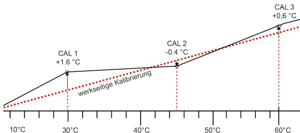
Exemple : Un écart de température doit être corrigé
