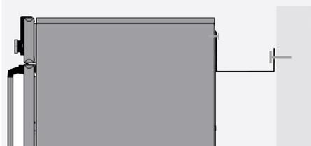
2. Plier le dispositif antibasculement vers le haut à la distance souhaitée pour former un angle à 90° avec le mur (veiller à laisser un écart minimum avec le mur).
