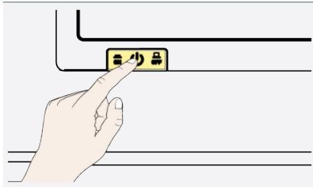
1. Allumer l'appareil en appuyant sur l'interrupteur principal se trouvant sur la façade de l'appareil.
