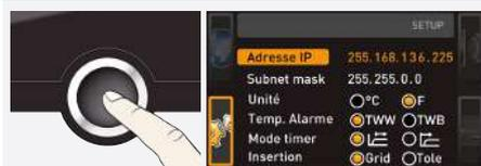
5. Après le paramétrage du dernier bloc de chiffres de la nouvelle adresse IP, confirmer à l'aide de la touche de validation.
