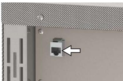
Depuis l'interface Ethernet, l'appareil peut être connecté à un réseau, de sorte que les programmes créés avec le logiciel AtmoCONTROL puissent être transférés à l'appareil et que les protocoles puissent être lus.
