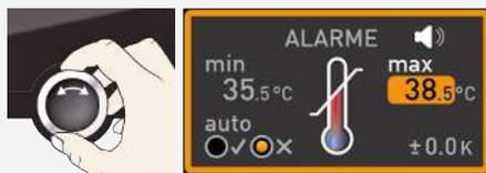
4. À l'aide du bouton rotatif, régler la valeur limite supérieure de l'alarme souhaitée.
