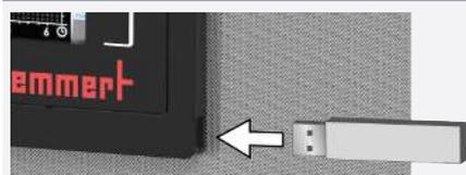
1. Insérer le support de données USB à droite dans le ControlCOCKPIT.
