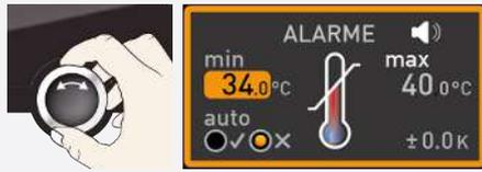
2. À l'aide du bouton rotatif, régler la valeur limite inférieure de l'alarme souhaitée.
