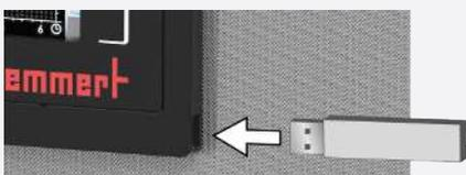
1. Insérer le support de données USB dans le connecteur à droite du ControlCOCKPIT.
