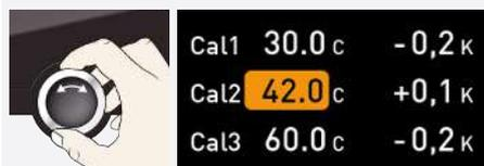
3. À l'aide du bouton rotatif, régler la température d'étalonnage Cal2 sur la température indiquée.
