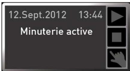
Lorsque l'appareil est en mode minuterie, cela est signalé par l'affichage Minuterie active.
