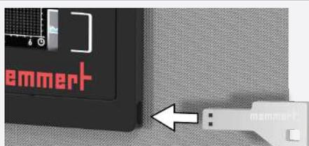
1. Insérer le support de données USB contenant les données ID utilisateur dans le connecteur à droite de ControlCOCKPIT.
