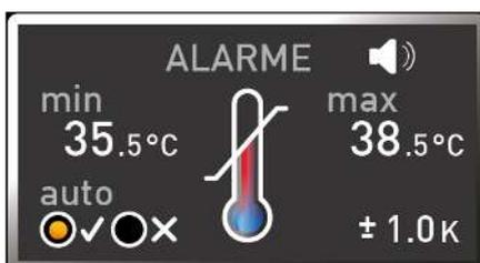
La température d'intervention du dispositif électronique de sécurité thermique est mesurée à l'aide d'une thermosonde Pt100 indépendante dans le caisson intérieur. Les réglages du dispositif de sécurité thermique sont effectués dans l'affichage **ALARME**. Les réglages effectués sont pris en compte dans tous les modes de fonctionnement.
