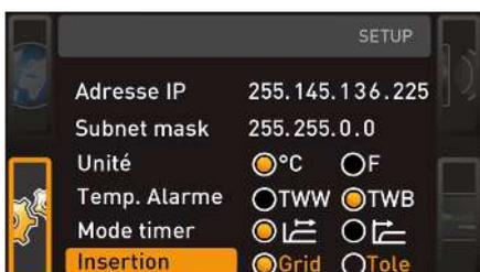
C'est ici que l'on détermine le type d'accessoire à insérer (grille ou plateau). Le choix **Plateau** permet d'ajuster la fonction de régulation aux différentes propriétés d'écoulement dans le caisson intérieur si vous utilisez les plateaux insérables en option au lieu des grilles fournies dans la livraison standard.
