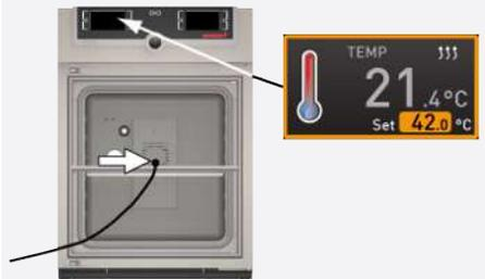
7. Mettre la sonde d'un instrument de mesure étalon au milieu du caisson intérieur de l'appareil.
