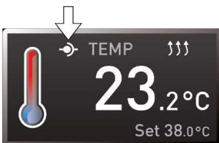
Lorsque l'appareil est en mode télécommande, cela est signalé par le symbole
