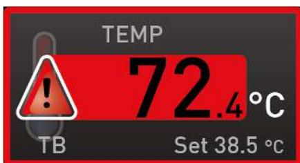
L'appareil est équipé d'un limiteur de température mécanique (TB), classe de protection 1 selon la norme DIN 12880.
