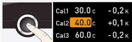
2. Appuyer sur la touche de validation jusqu'à ce que la température d'étalonnage Cal2 soit sélectionnée.
