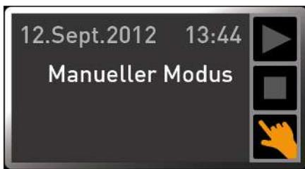
In welcher Betriebsart bzw. welchem Betriebszustand sich das Gerät gerade befindet, wird in der Statusanzeige angezeigt. Der jeweilige Betriebszustand ist an der farbigen Markierung und der Textanzeige zu erkennen:
