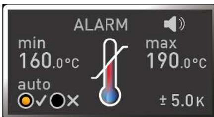
Die Überwachungstemperatur der elektronischen Temperaturüberwachung wird über einen separaten Pt100-Temperatursensor im Innenraum gemessen. Die Einstellungen zur Temperaturüberwachung werden in der Anzeige **ALARM** vorgenommen. Die vorgenommenen Einstellungen sind in allen Betriebsarten wirksam.
