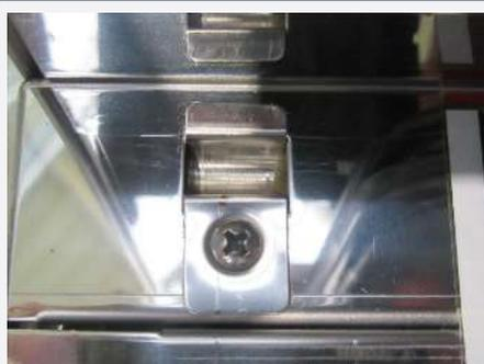
1. Lösen Sie die Kreuzschraube der Verschlussbolzen-Aufnahme am unteren Querrahmen mit einem Schraubendreher.
