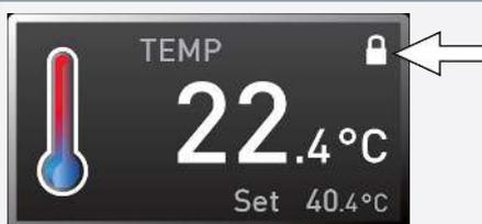
Auch Einstellmöglichkeiten im Menümodus (z.B. Justieren oder das Verstellen von Datum und Uhrzeit) können damit gesperrt werden.
