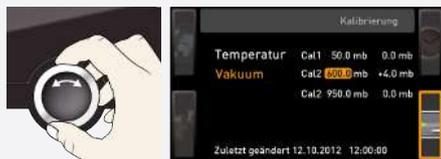
5. Stellen Sie mit dem Drehknopf den Abgleichpunkt **Cal2** auf 600 mbar ein.
