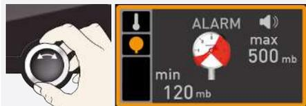
2. Drehen Sie den Drehknopf, bis die Druckeinstellung ● markiert ist.
