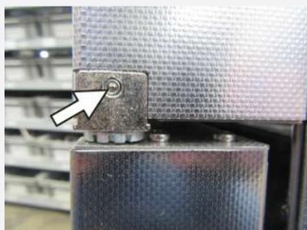
1. Öffnen Sie die Madenschraube auf der Stirnseite des Türscharniers mit einem Innensechskantschlüssel (Gr. 2).
