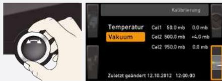
3. Drehen Sie den Drehknopf, bis **Vakuu** markiert ist.
