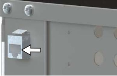
Über eine Ethernet-Schnittstelle kann das Gerät an ein Netzwerk angeschlossen und mit der Software AtmoCONTROL erstellte Programme auf das Gerät überspielt und Protokolle ausgelesen werden.
