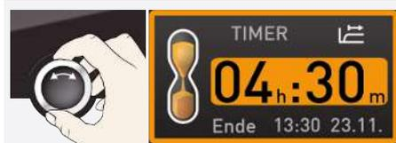
2. Drehen Sie den Drehknopf, bis die gewünschte Laufzeit angezeigt wird.
