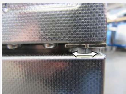
2. Drehen Sie die Lagerung (Exzenter) der Tür mit einem Schlitzschraubendreher nach Bedarf im Uhrzeigersinn bzw. gegen den Uhrzeigersinn.
