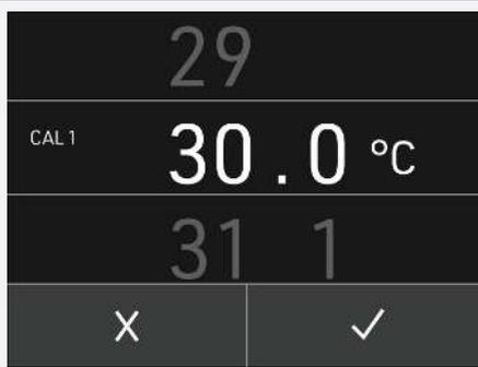
3. Stellen Sie über vertikales Scrollen die Abgleichtemperatur **CAL1** auf 30 °C ein.
