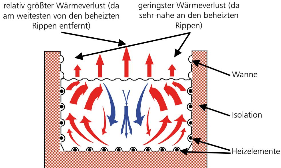
Bedingt durch die an drei Seiten angeordnete Beheizung des Badbehälters (Boden und beide Seitenwände) entsteht eine natürliche Zirkulation der Badflüssigkeit und damit eine optimale, homogene Temperaturverteilung.
