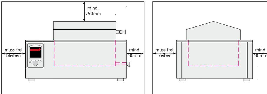
Bei Aufstellung des Gerätes ist auf eine waagerechte, kipp sichere, nicht brennbare Stellfläche zu achten.
