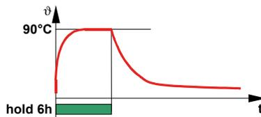
Das Gerät schaltet nach Ablauf der eingestellten Haltezeit die Heizung ab. Die Haltezeit schließt in diesem Fall die Aufheizzeit mit ein.
