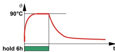
Au terme de la durée programmée pour le maintien du plateau de consigne, le chauffage s'arrête. Le temps compté inclut la montée en température
