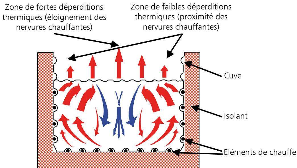
Le chauffage réparti sur trois parois de la cuve (fond et les deux parois latérales) provoque un courant de brassage naturel du liquide. Par conséquent, il y a la homogénéité de distribution de température la meilleure possible.
