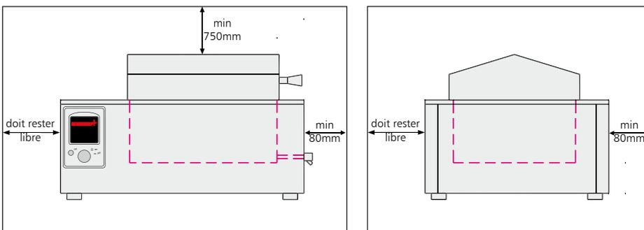
Le bain doit être installé sur une surface stable, plane et horizontale non-inflammable.
