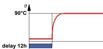
L'appareil commence à chauffer en vue de la température de consigne après écoulement du temps d'attente programmé pour le délai différé
