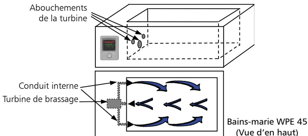
L'utilisation d'une pompe ou turbine de brassage permet d'améliorer l'homogénéité de la température du bain. L'aspiration s'effectue au milieu du bain et le refoulement passe par conduits internes pour une répartition à l'avant et à l'arrière de la cuve. L'eau circulant en continu, il en résulte en permanence une meilleure homogénéité. Sur un bain réglé à 90°C l'inhomogénéité est inférieure à 0,36°C sur l'ensemble du bain.
