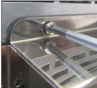
Abb. 5 Abluftanlage festschrauben
