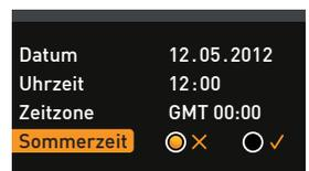
6. Auswahl mit der Bestätigungstaste bestätigen. Es werden die Einstellmöglichkeiten markiert.
