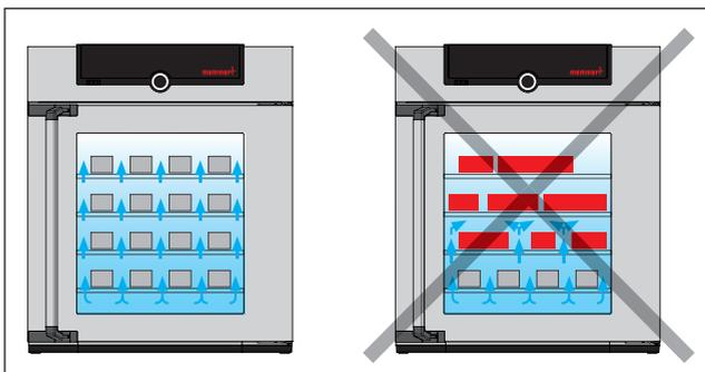
Abb. 13 Korrekte Platzierung des Beschickungsguts
