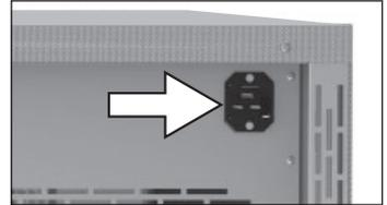
Abb. 10 Netzkabel an der Geräterückseite anschließen
