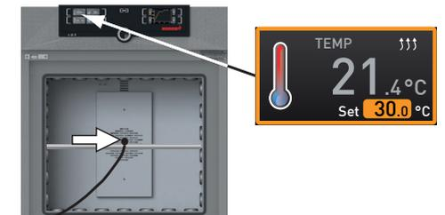
8. Warten, bis das Gerät die Solltemperatur erreicht hat und 30 °C anzeigt. Das Referenzmessgerät zeigt angenommen 31,6 °C.
