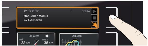
2. Drehknopf drehen, bis das Startsymbol ▶ markiert ist. Es wird das aktuell zur Verfügung stehende Programm angezeigt, in diesem Beispiel Test 012.
