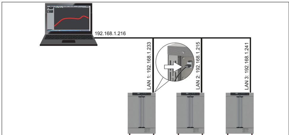
Abb. 21 Betrieb mehrerer Geräte in einem Netzwerk (schematisches Beispiel)
