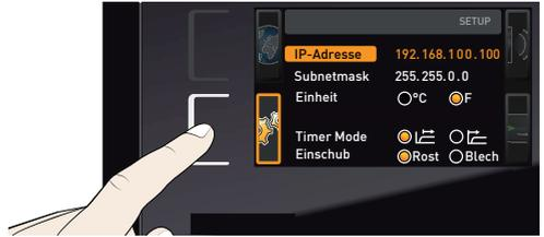
2. Auswahl mit der Bestätigungstaste bestätigen. Es wird automatisch der erste Ziffernblock der IP-Adresse markiert.
