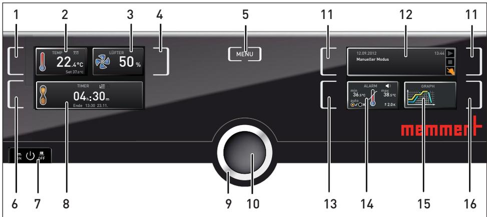
Abb. 14 ControlCOCKPIT im Betriebsmodus (Breite kann je nach Gerätegröße abweichen)
