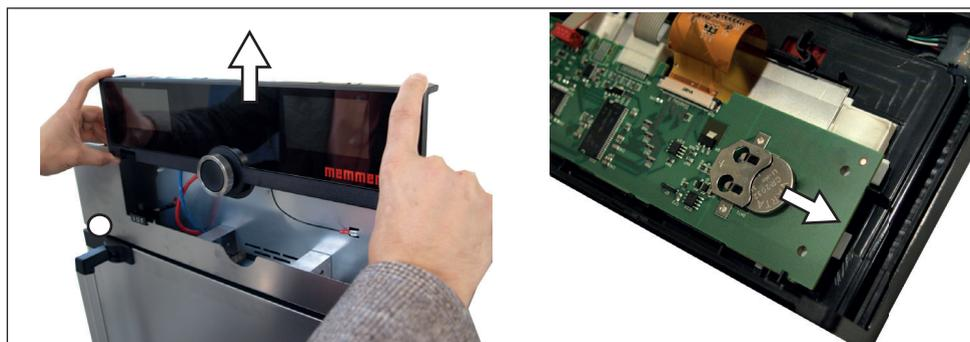
Abb. 26 Lithiumbatterie entfernen
