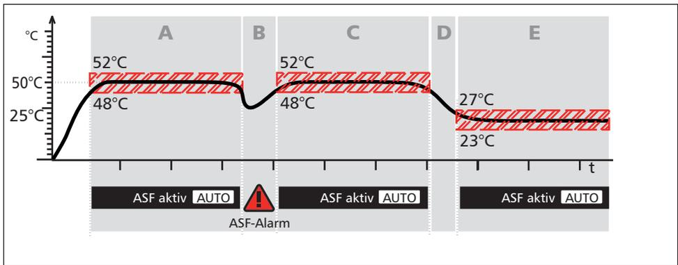
Abb. 17 Schematische Darstellung Funktionsweise ASF-Temperaturüberwachung
