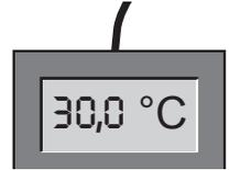
Mit Cal1 kann auf dieselbe Weise eine weitere Abgleichtemperatur unterhalb von Cal2 justiert werden, mit Cal3 eine darüberliegende. Der Mindestabstand zwischen den Cal-Werten beträgt 10 K.
