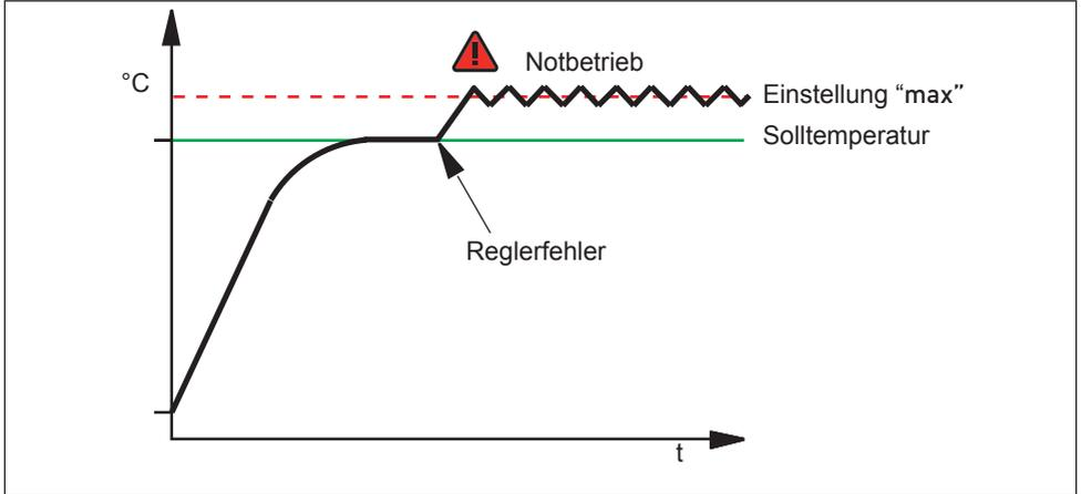
Abb. 16 Schematische Darstellung Funktionsweise TWW-Temperaturüberwachung
