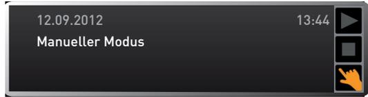
Im Beispiel rechts befindet sich das Gerat im manuellen Betrieb, erkennbar am farbigen Handsymbol.
