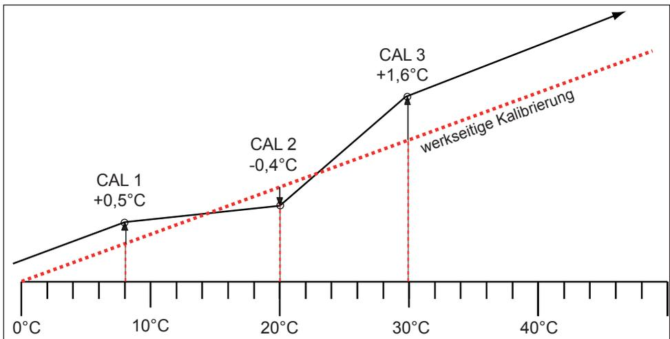
Abb. 23 Schematisches Beispiel Temperaturjustierung
