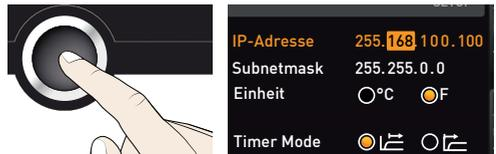
5. Nach Einstellung des letzten Ziffernblocks die neue IP-Adresse mit der Bestätigungstaste bestätigen. Die Markierung springt wieder zurück in die Übersicht. Auf die gleiche Weise kann die Subnetzmaske eingestellt werden.
