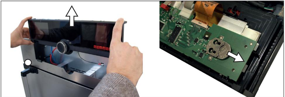
Abb. 23 Lithiumbatterie entfernen
