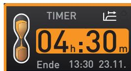
1. Bis 23 Stunden 59 Minuten wird die Zeit im Format hh:mm (Stunden:Minuten) angezeigt, ab 24 Stunden im Format dd:hh (Tage:Stunden). Die maximale Laufzeit beträgt 99 Tage und 00 Stunden.
