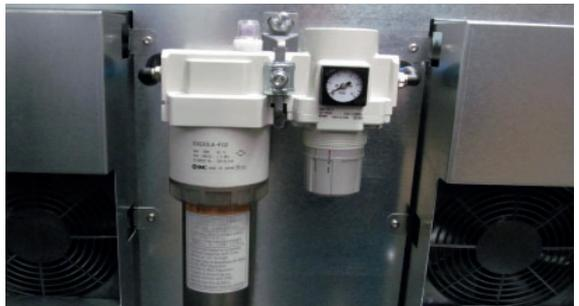
An der Drucklufttrocknungseinheit an der Geräterückseite kann am Drehregler der Druck manuell eingestellt werden:
