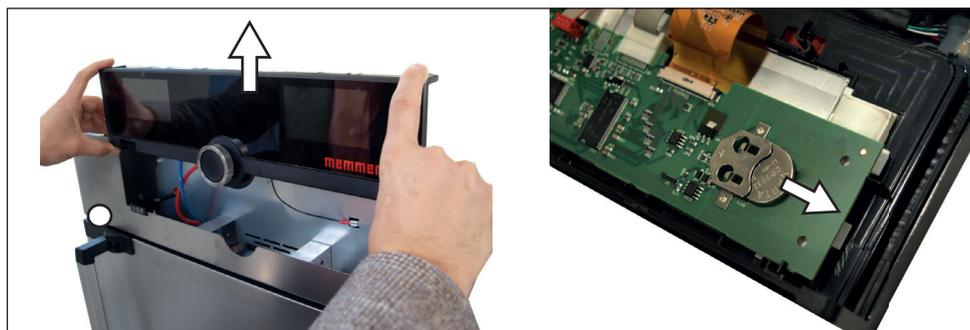
Fig. 32 Retirar la batería de litio
