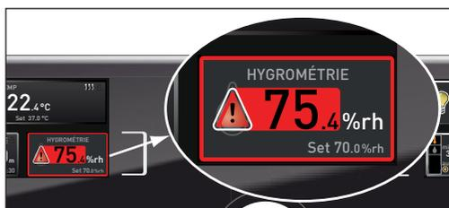
Ill. 22 Déclenchement du dispositif de sécurité hygrométrique
