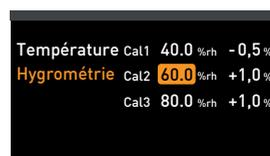
5. Appuyer sur la touche de validation pour enregistrer le réglage. La valeur corrective d'étalonnage correspondante est automatiquement indiquée.
