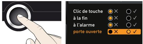
3. À l'aide du bouton rotateur, sélectionner le réglage souhaité.
