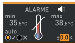
7. À l'aide du bouton rotateur, régler la zone de tolérance souhaitée, par ex., 2.0 K.
