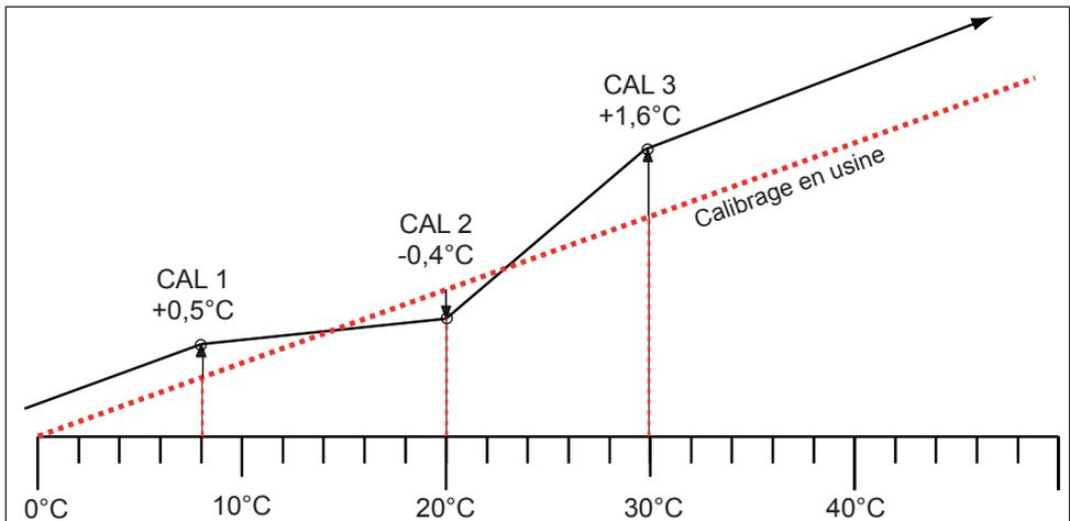
Ill. 28 Schéma illustrant l'étalonnage de la température
