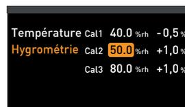
4. À l'aide du bouton rotateur, régler le point d'étalonnage Cal2 sur 60 % h.r.
