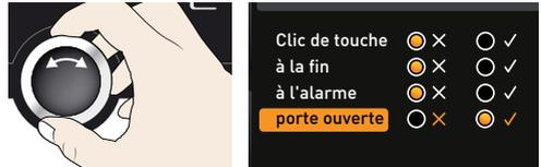
2. Accepter la sélection avec la touche de validation. Les possibilités de réglage sont automatiquement indiquées en orange.
