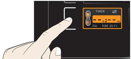
2. Tourner le bouton rotateur jusqu'à ce que la durée de cycle souhaitée s'affiche – dans cet exemple, 4 heures et 30 minutes –. L'heure de fin prévue figure en dessous en petits caractères.
