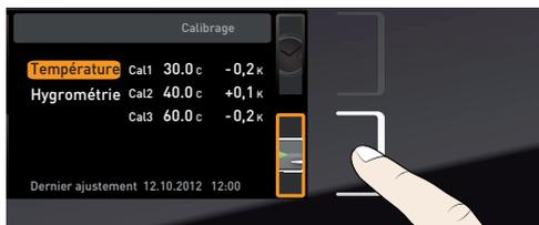
2. Appuyer sur la touche de validation jusqu'à ce que la température d'étalonnage Cal2 soit sélectionnée.
