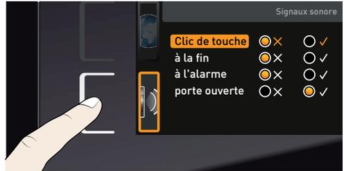
2. Si vous souhaitez modifier un autre élément de la liste : tourner le bouton rotateur jusqu'à ce que l'élément souhaité – par ex., porte ouverte (Option) – soit sélectionné en orange.
