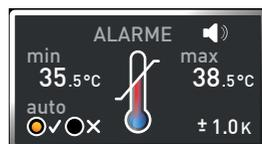
Dès que le dispositif de sécurité thermique est déclenché, cet événement est signalé dans l'affichage de la température par la température effective indiquée en rouge et par un symbole d'alarme
