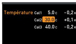
4. Appuyer sur la touche de validation pour enregistrer le réglage. La valeur corrective d'étalonnage correspondante est automatiquement indiquée.
