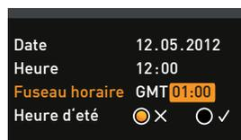
4. Avec le bouton rotateur, régler le fuseau horaire en fonction de la localisation de l'appareil, par ex., 00:00 pour le Royaume-Uni, 01:00 pour la France, l'Espagne ou l'Allemagne. Confirmer le réglage avec la touche de validation.
