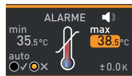
4. Appuyer sur la touche de validation pour enregistrer la valeur limite supérieure de l'alarme. Le réglage du thermostat automatique (ASF) est automatiquement activé (auto).
