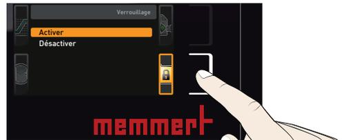
3. Appuyer sur la touche de validation pour accepter l'activation. Les nouvelles données ID utilisateur sont transférées dans le support de données USB et sont activées. À la fin du processus d'activation, une coche apparaît devant la commande.
