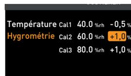
6. Régler le correctif d'étalonnage sur 0,0 % et enregistrer ce réglage en appuyant sur la touche de validation.
