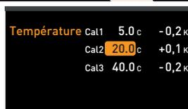
3. À l'aide du bouton rotateur, régler la température d'étalonnage Cal2 sur 30 °C.
