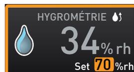
Une humidité importante de l'air dans le caisson intérieur sans condensation peut être uniquement atteinte si le caisson intérieur est chauffé intégralement. Pour cette raison, la vitesse d'approche est réglée dynamiquement sur la valeur de consigne de l'humidité en fonction de la température du caisson intérieur.
