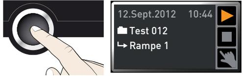
**i** Pendant l'exécution d'un programme, il est impossible de procéder à une quelconque modification de paramètre (par ex., de température) de l'appareil. Les affichages ALARME et GRAPHIQUE restent toutefois accessibles.
