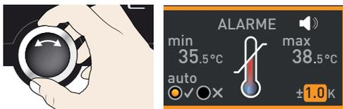
8. Appuyer sur la touche de validation pour confirmer. Le dispositif de sécurité thermique est maintenant activé.
