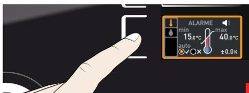
Accepter la sélection avec la touche de validation. Le réglage min. (protection en cas de sous-température) est automatiquement activé.
