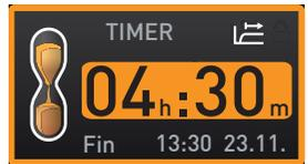
**i** L'heure est indiquée au format hh:mm (heures:minutes) jusqu'à 23 heures et 59 minutes ; au-delà de 24 heures, le format dd:hh (jours:heures) est adopté. La durée maximale d'un cycle est de 99 jours et 00 heures.
