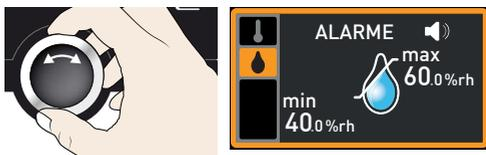
3. Accepter la sélection avec la touche de validation. La valeur limite inférieure de l'alarme pour l'humidité est automatiquement indiquée.
