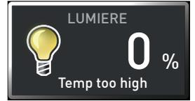
**i** L'éclairage du caisson intérieur est activé jusqu'à une température de 40 °C. Au-delà de cette température, il est éteint automatiquement. L'écran lumineux affiche alors « Temp too high »
