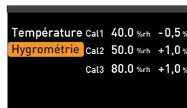
3. Appuyer sur la touche de validation jusqu'à ce que le point d'étalonnage Cal2 soit sélectionné.
