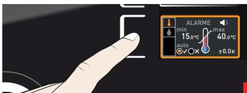
2. Tourner le bouton rotateur jusqu'à l'affichage du réglage de l'humidité 🌧️.
