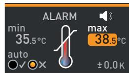
4. Premere OK per salvare il limite superiore di allarme. Si attiva automaticamente l'impostazione del dispositivo (ASF) (auto).
