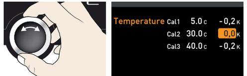
6. Posizionare il sensore di un apparecchio di misurazione calibrato al centro dell'interno della camera.
