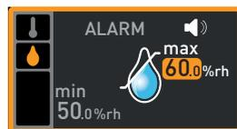
6. Con l'ausilio della manopola impostare il limite superiore di allarme desiderato, nell'esempio a destra 70% rh.
