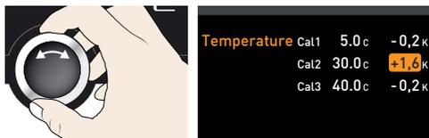
10. Dopo la procedura di regolazione, anche la temperatura misurata dall'apparecchio di misurazione di riferimento deve essere ora 30° C.
