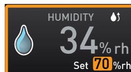
Per raggiungere un'elevata umidità dell'aria nella camera senza formazione di condensa è necessario che la camera sia stata completamente riscaldata. La velocità di avvicinamento al valore nominale viene pertanto regolata dinamicamente in base alla temperatura della camera.
