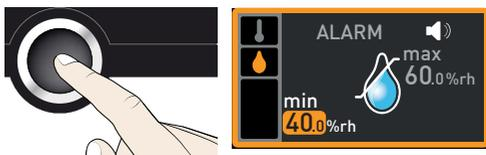
4. Con l'ausilio della manopola impostare il limite inferiore di allarme desiderato, nell'esempio a destra 50% rh.
