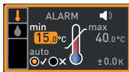
1. Con l'ausilio della manopola impostare il limite inferiore di allarme desiderato, nell'esempio a destra 35,5°C.
