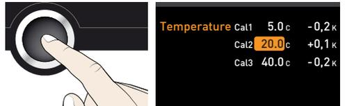
3. Con l'ausilio della manopola impostare la temperatura di compensazione Cal2 a 30 °C.
