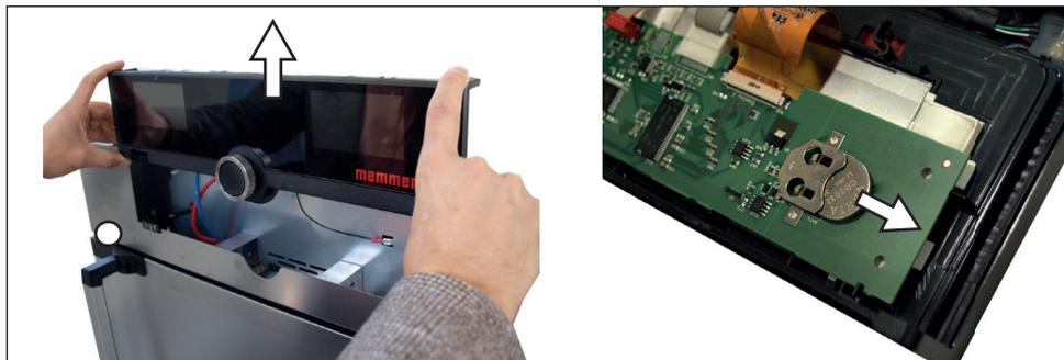
Fig. 32 Rimuovere la batteria al litio
