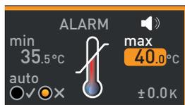
3. Con l'ausilio della manopola impostare il limite superiore di allarme desiderato, nell'esempio a destra 38,5°C.
