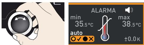
6. Presione la tecla de confirmación para confirmar. A continuación se activa el ajuste de la banda de tolerancia ASF.
