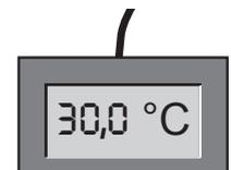
Con Cal1 se puede ajustar del mismo modo otra temperatura de compensación por debajo de Cal2 y con Cal3 una temperatura de compensación por encima. Entre los valores Cal debe existir una diferencia mínima de 10 K.
