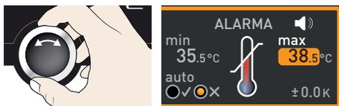
4. Acepte el límite superior de alarma presionando la tecla de confirmación. El ajuste del controlador de temperatura de protección automático (ASF) se activa de forma automática (auto).
