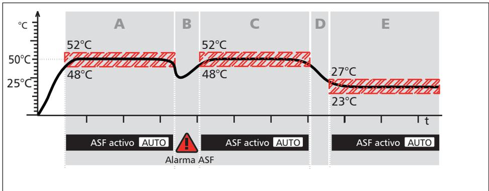
Fig. 17 Representación esquemática del modo de funcionamiento de la vigilancia de temperatura ASF
