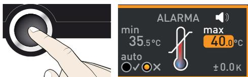
3. Ajuste el límite superior de alarma deseado con el botón giratorio, en el ejemplo de la derecha 38,5 °C.
