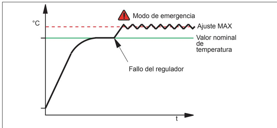
Fig. 16 Representación esquemática del modo de funcionamiento de la vigilancia de temperatura TWW
