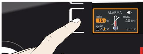
1. Ajuste el límite inferior de alarma deseado con el botón giratorio, en el ejemplo de la derecha 35.5 °C.
