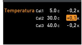
5. Ajuste el valor de compensación a 0,0 K y guarde la configuración presionando la tecla de confirmación.
