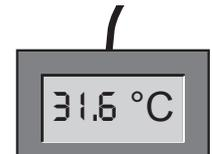
9. Ajuste en SETUP el valor de compensación de Cal2 a +1,6 K (el valor real registrado menos el valor nominal) y guarde la configuración presionando la tecla de confirmación.
