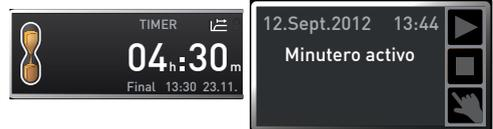
4. Ahora puede configurar por separado según se ha descrito en el capítulo 5.4.2 los valores con los que el equipo debe funcionar durante el tiempo ajustado. Es posible modificar los valores configurados durante el tiempo de funcionamiento con temporizador. El cambio se aplicará de forma inmediata.
