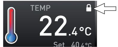
Fig. 24 Función de cambio del ajuste de temperatura en el equipo bloqueada (ejemplo)
