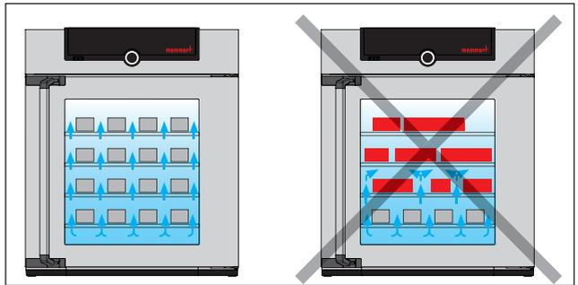
Fig. 13 Colocación correcta de la carga
