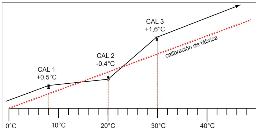
Fig. 23 Ejemplo esquemático del ajuste de rectificación de la temperatura
