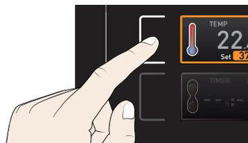
2. Ajuste el valor nominal deseado girando (p. ej., 37.0 °C) girando el botón giratorio a derecha o izquierda.
