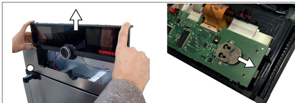
Fig. 26 Rimuovere la batteria al litio
