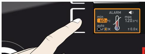
1. Con l'ausilio della manopola impostare il limite inferiore di allarme desiderato, nell'esempio a destra 35,5°C.
