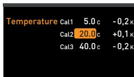
3. При помощи поворотного-нажимного регулятора установите температуру калибровки Cal2 на 30°C.
