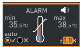
7. При помощи поворотного-нажимного регулятора отрегулируйте необходимый интервал допуска (например, 2,0 K).
