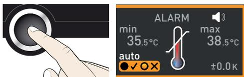
5. С помощью поворотной-нажимного регулятора установите ON (✓) или OFF (✗).
