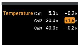
10. После завершения калибровки температура, измеренная эталонным прибором, также должна быть 30 °С.
