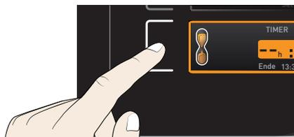
2. Поворачивайте поворотный-нажимной регулятор, пока не будет отображена необходимая продолжительность - в данном примере 4 часа 30 минут. Ожидаемое время окончания работы отображается внизу мелким шрифтом.
