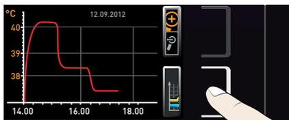
▶ Для изменения отображаемого периода времени: нажмите кнопку активации рядом с символами стрелок <D>. Теперь период времени можно изменить с помощью поворотного-нажимного регулятора.
