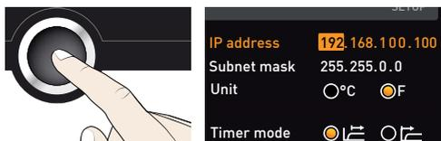
3. При помощи поворотного-нажимного регулятора установите новое число, например 255.
