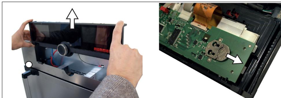
Рис. 26 Извлечение литиевого аккумулятора
