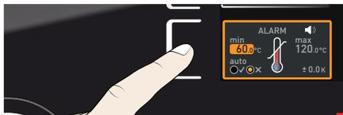
1. Поворачивая поворотной-нажимной регулятор, установите нужное минимальное значение для аварийного сигнала, в примере справа: 35,5 °С.
