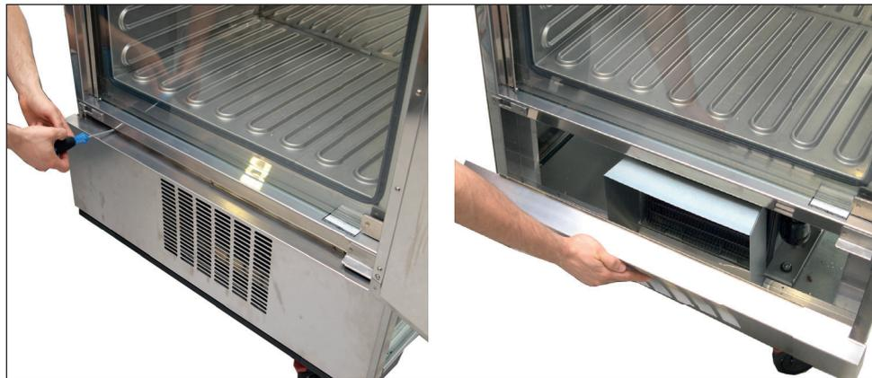
Рис. 25 Отвинтить переднюю панель
