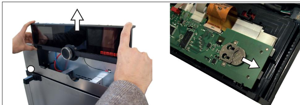
Fig. 23 Retirar la batería de litio
