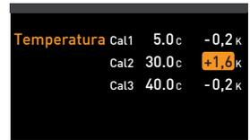
10. Después del proceso de regulación, la temperatura registrada por la sonda de referencia debería indicar ahora 30 °C.
