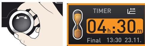
**i** El tiempo se muestra con el formato hh:mm (horas:minutos) hasta una duración de 23 horas y 59 minutos; a partir de 24 horas el formato cambia a dd:hh (días:horas). El tiempo de duración máximo son 99 días y 00 horas.
