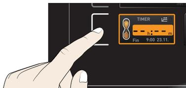
2. Tourner le bouton rotateur jusqu'à ce que la durée de cycle souhaitée s'affiche – dans cet exemple, 4 heures et 30 minutes–. L'heure de fin prévue figure en dessous en petits caractères.
