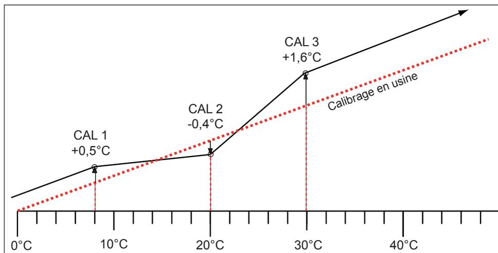
Ill. 21 Schéma illustrant l'étalonnage de la température
