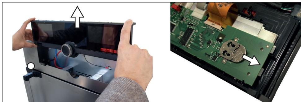
Fig. 22 Rimuovere la batteria al litio
