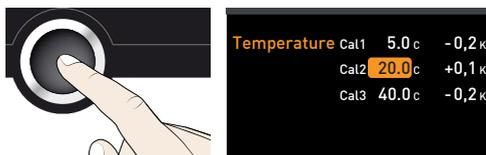
3. Con l'ausilio della manopola impostare la temperatura di compensazione Cal2 a 30 °C.
