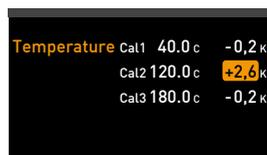
10. После завершения калибровки измеренная эталонным прибором температура также должна составлять 120 °C.
