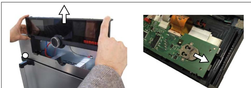
Рис. 24 Извлечение литиевого аккумулятора
