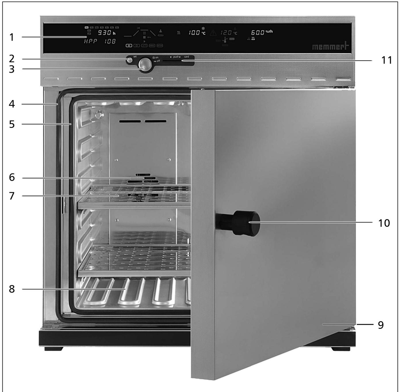
Abb. 2 Aufbau von Konstantklima-Kammern HPP
