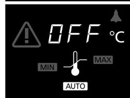
**i** Das Toleranzband für den ASF kann im SETUP im Bereich 0,5 ... 5 °C eingestellt werden (siehe Seite 54).
