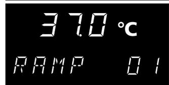
7. Lüfterdrehzahl des ersten Rampensegments einstellen: Drück-Dreh-Geber nach rechts drehen, bis die Lüfteranzeige blinkt.
