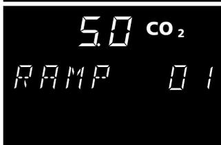
10. Beleuchtungsart des ersten Rampensegments einstellen (nur bei Geräten mit Beleuchtung, sonst weiter mit Punkt 11.):
