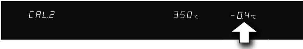
4. Das Referenzmessgerät sollte nach dem Einregelvorgang nun  $35\text{ °C}$  anzeigen.
