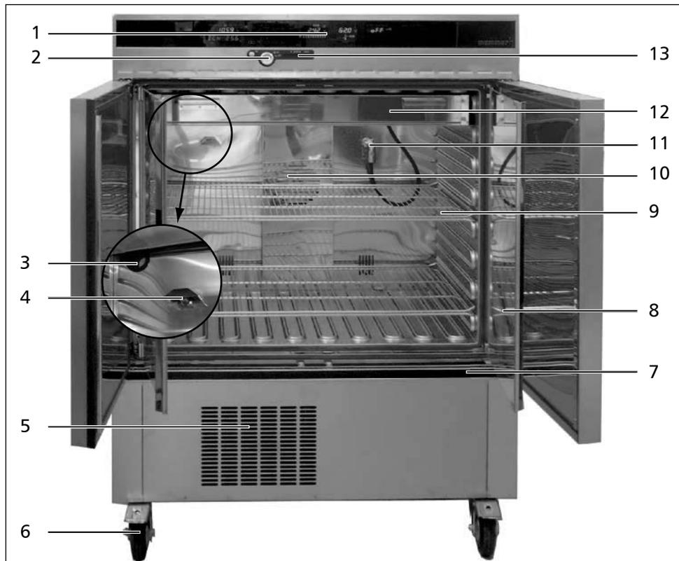
Fig. 3 Estructura de los incubadores refrigerados ICH
