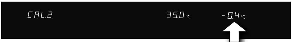
4. La sonda de referencia debería indicar 35°C después del proceso de regulación.
