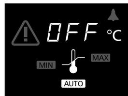
**i** La banda de tolerancia para el ASF se puede ajustar en SETUP dentro del rango 0,5 ... 5°C (véase la página 55).
