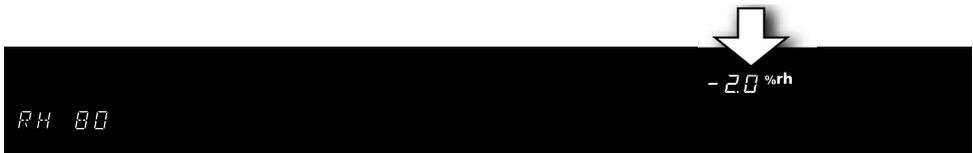
4. La sonda de referencia debería mostrar 80,0% rh después del proceso de regulación. Con RH 20 se puede programar otro valor de compensación para el 20% de humedad relativa.
