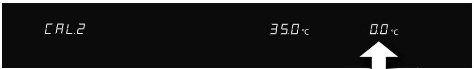
2. Con una sonda de referencia calibrada, se mide con una temperatura nominal ajustada de 35°C una temperatura real de 34,6°C.
