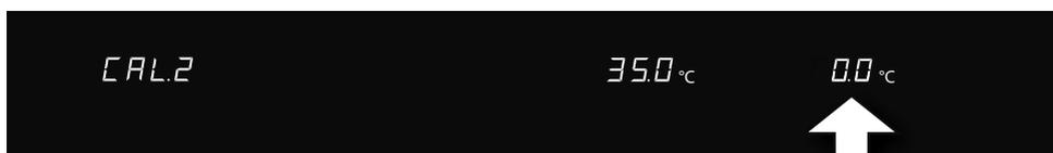
2. L'appareil étant réglé en mode normal sur la température de consigne de 35 °C, on mesure une température effective de 34,6 °C à l'aide d'un thermomètre étalon.
