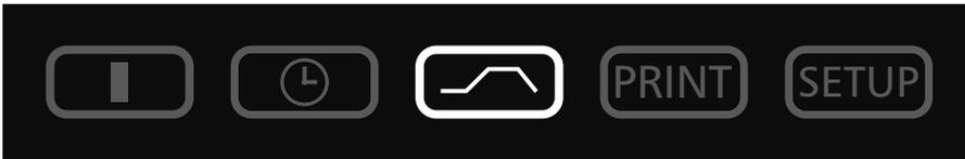
En este modo de servicio se pueden ajustar hasta 40 rampas de temperatura-tiempo programables. Girando el mando giratorio/pulsador con la tecla set presionada se pueden seleccionar por orden los siguientes parámetros. Después de soltar la tecla set
