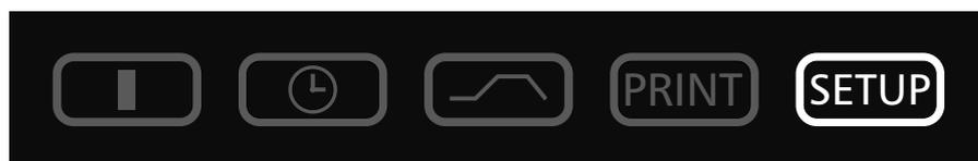
En este modo de servicio se pueden llevar a cabo ajustes básicos del aparato. Aquí se ajustan hora, fecha, día, año, así como la señal acústica, la asignación de dirección en la memoria, las unidades de control, la potencia calorífica y el calibrado.
