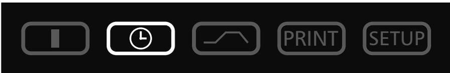
En este modo de servicio está activado el reloj semanal y la estufa se conecta y se desconecta automáticamente a las horas prefijadas.
