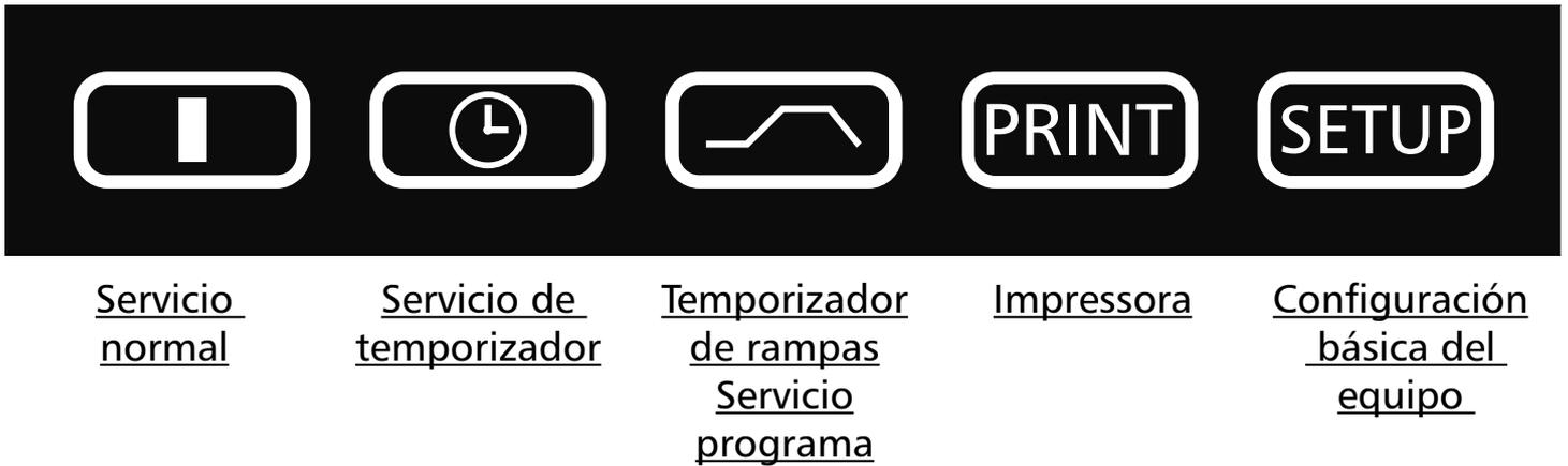
Después de apretar la tecla set durante unos 3 segundos el modo de servicio actual parpadea. Se puede seleccionar ahora mediante el mando giratorio/pulsador, manteniendo pulsada la tecla SET, el nuevo modo de servicio. Después de soltar la tecla set, el regulador trabaja en el nuevo modo de servicio.
