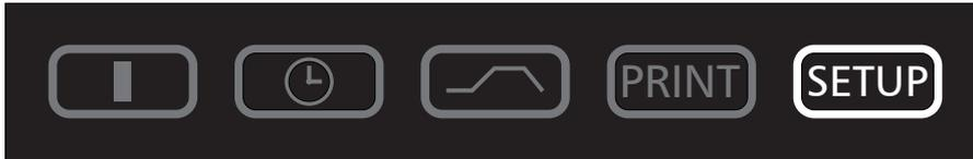
In Questa modalità di funzionamento è possibile effettuare le impostazioni di base dell'apparecchio. In questa modalità operativa è possibile impostare i parametri di base dello strumento: l'orologio, la data, il giorno, l'anno, i segnali di avviso sonori, l'indirizzo di assegnazione, le unità di monitoraggio, la potenza del riscaldamento e i fattori di calibrazione.
