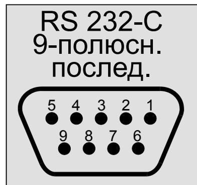
рис. 31 Интерфейс RS-232-C
