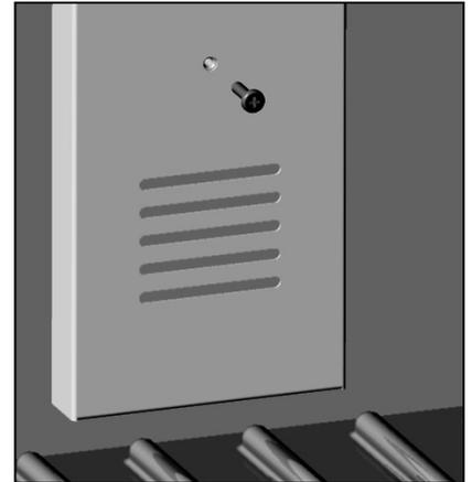
рис. 36 Для снятия крышки вентилятора открутите два винта
