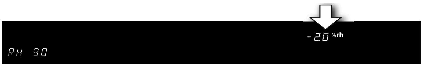
4. После процесса регулировки эталонных измерительный прибор должен показывать 90,0 % rh.
