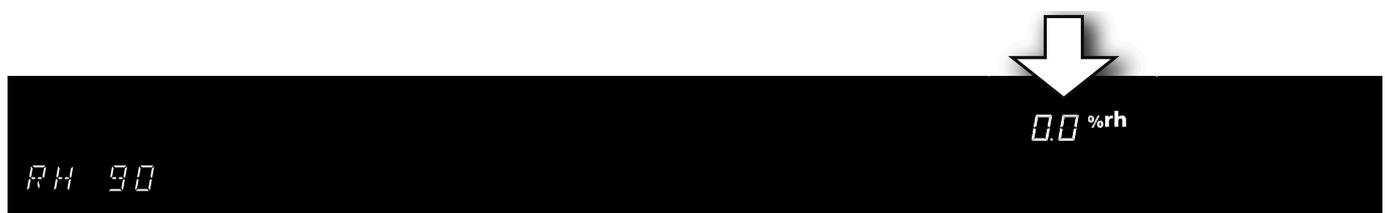
2. С помощью калиброванного эталонного измерительного прибора в стандартном режиме при заданном значении влажности 90 %rh измерена фактическая влажность 88 % rh.
