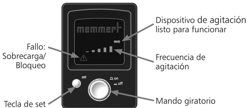
Después de conectar el dispositivo de agitación, el valor teórico para la frecuencia de sacudida está ajustado siempre a 0 carreras por minuto.
