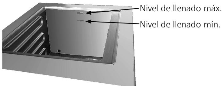
Tenga en cuenta que debe utilizar agua desmineralizada como fluido de atemperación para proteger el baño y el dispositivo de agitación de acero inoxidable. El baño debe llenarse de forma que el nivel del líquido se encuentre entre las dos señales de nivel de llenado de la parte interior derecha de la cubeta (con el dispositivo de agitación cargado).
