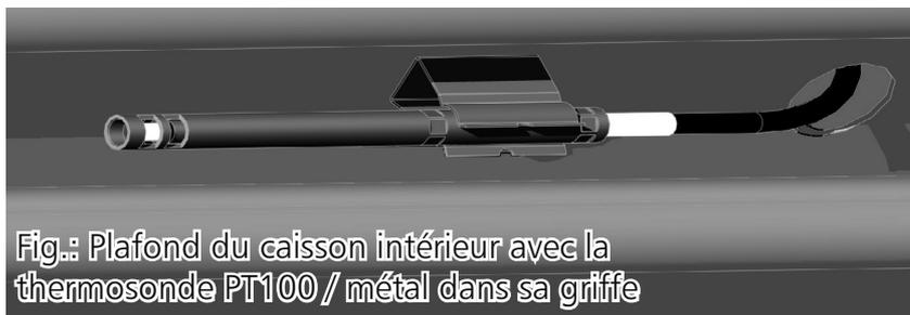
Fig.: Plafond du caisson intérieur avec la thermosonde PT100 / métal dans sa griffe
