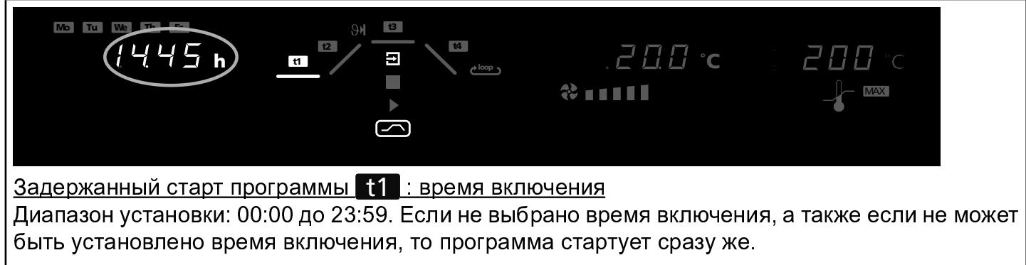
Диапазон установки: 00:00 до 23:59. Если не выбрано время включения, а также если не может быть установлено время включения, то программа стартует сразу же.
