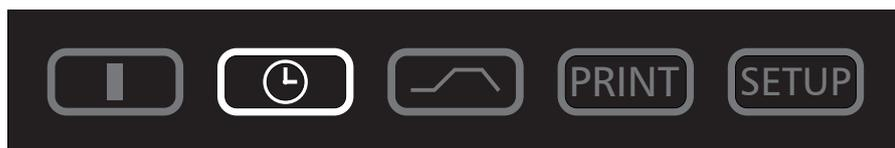
In questa modalità operativa viene attivato il programmatore settimanale che inserisce e disinserisce il riscaldamento automaticamente in corrispondenza degli orari programmati.
