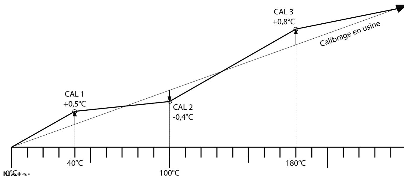
En remettant toutes les valeurs de compensation sur 0mB, on revient sur les calibrages effectués en usine.
