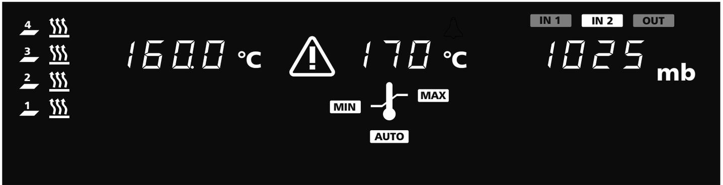
Maintenir la touche „set“ en position active et sélectionner les paramètres à l'aide du bouton rotateur. Pour tout détail relatif à ces manipulations, se reporter au chapitre „Installation des paramètres“:
