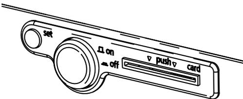
L'étuve est arrêtée. Le bouton-rotateur est en position enfoncée et n'offre ainsi pas de prise pour être endommagé.
