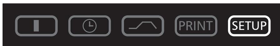
В этом режиме работы могут быть использованы базовые установки устройства. Могут быть установлены: время часов, дата, день, год, а также установки сирены, распределение адресов памяти, параметры контроля, мощность нагрева и калибровка.
