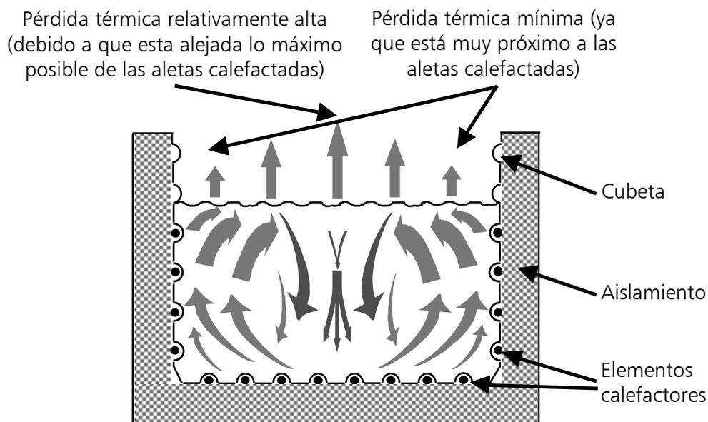
Causado por la calefacción emplazada en tres lados alrededor de la cubeta (al fondo y ambos lados) se produce una circulación natural del líquido en eso y por consiguiente una distribución óptima y homogénea de la temperatura.
