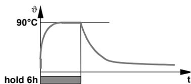
El aparato se desconecta la calefacción después del tiempo de retención. El tiempo de retención incluye en este caso el tiempo de calentamiento.
