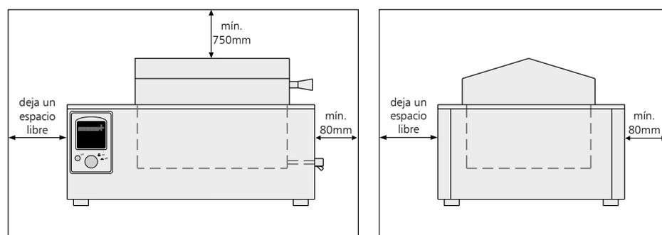
En el emplazamiento del aparato se deberá observar que queden situados sobre una superficie de asiento horizontal, asegurada contra vuelco y no inflamable.
