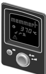
Выключение устройства: Поворотно-нажимная кнопка утоплена и защищена от повреждений.
