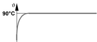
L'appareil démarre immédiatement le chauffage pour la température programmée
