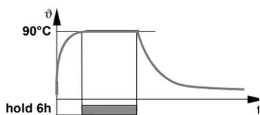
Au terme de la durée programmée pour le maintien du plateau de consigne, le chauffage s'arrête. Décompte de la durée du plateau à partir de l'obtention de la température de consigne
