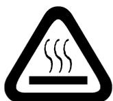
Le marquage ci-contre, apposé sur l'armoire, signifie qu'il convient de respecter le mode d'emploi de façon stricte, et de faire valoir la prudence, l'appareil pouvant être brûlant au cours de son fonctionnement.
