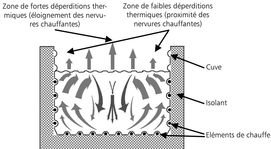
Le chauffage réparti sur trois parois de la cuve (fond et les deux parois latérales) provoque un courant de brassage naturel du liquide. Par conséquent, il y a la homogénéité de distribution de température la meilleure possible.
