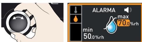
7. Presione la tecla de confirmación para aceptar los datos y finalice el proceso de ajuste realizado con el indicador Alarma presionando la tecla de activación lateral. El sistema de vigilancia de la humedad ya está activo.
