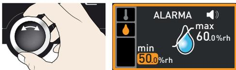
5. Acepte la selección con la tecla de confirmación. A continuación se resalta el límite superior de la alarma de humedad forma automática.
