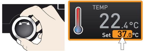
3. Guarde el valor configurado presionando la tecla de confirmación. El indicador vuelve al estado normal y el equipo inicia el proceso de ajuste conforme al valor configurado.
