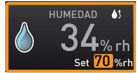
Niveles altos de humedad del aire en la cámara interior sólo se pueden lograr sin que haya condensación si la cámara interior se ha calentado completamente. Por eso, la velocidad de la regulación dinámica para aproximarse al valor de humedad de referencia, depende de la temperatura de la cámara interior.
