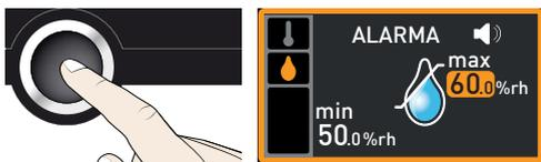
6. Ajuste el límite superior de alarma deseado con el botón giratorio, en el ejemplo de la derecha 70% rh.
