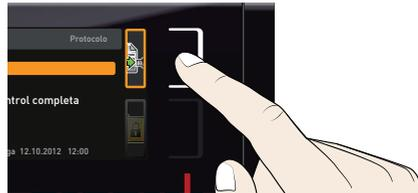
3. Acepte la selección presionando la tecla de confirmación. La transmisión de datos se inicia; un indicador de estado muestra el progreso del proceso.
