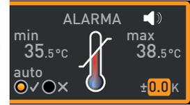
9. Ajuste la banda de tolerancia deseada con el botón giratorio, por ejemplo, 2.0 K.
