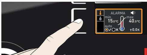
2. Acepte la selección presionando la tecla de confirmación. El ajuste mín. (protección contra temperatura inferior) se activa de forma automática.
