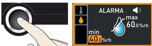
4. Ajuste el límite inferior de alarma deseado con el botón giratorio, en el ejemplo de la derecha 50% rh.
