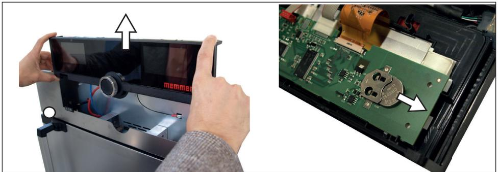
Fig. 38 Retirar la batería de litio
