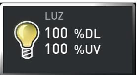
**i** En cuanto las cajas de iluminación estén encendidas, la unidad de refrigeración debe compensar el calor residual de las cajas de iluminación. Por lo tanto, el aparato sólo puede ser usado en un rango de temperatura y humedad restringido. Nosotros recomendamos una temperatura de 25 °C y una humedad máxima de 50 % HR. Según las condiciones ambientales, puede haber condensación en el interior.
