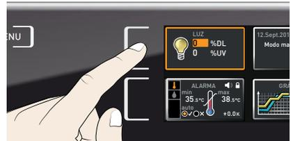
2. Ajuste el valor nominal de luz diurna deseado (0 % = apagado, 100 % = encendido) girando el botón a derecha o izquierda.
