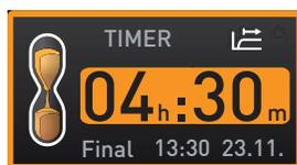
**i** El tiempo se muestra con el formato hh:mm (horas:minutos) hasta una duración de 23 horas y 59 minutos; a partir de 24 horas el formato cambia a dd:hh (días:horas). El tiempo de duración máximo son 99 días y 00 horas.
