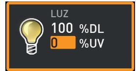
4. Ajuste el valor nominal de luz UV deseado (0 % = apagado, 100 % = encendido) girando el botón a derecha o izquierda.
