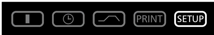
In dieser Betriebsart können die Grundeinstellungen des Gerätes vorgenommen werden. Hier werden Uhrzeit, Datum, Tag, Jahr sowie die Einstellungen der Hupe, der Adressenzuweisung, der Überwachungseinheiten, der Heizleistung und der Kalibrierung eingestellt.
