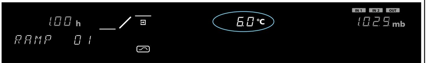
Solltemperatur/Temperatur zum Ende des Rampensegments
