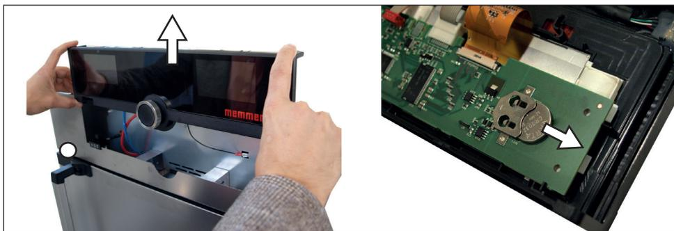
Fig. 25 Rimuovere la batteria al litio
