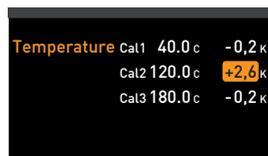
10. Dopo la procedura di regolazione, anche la temperatura rilevata dal misuratore di riferimento deve essere ora 120° C.
