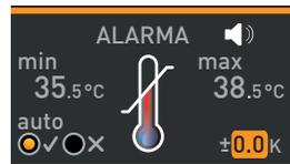
9. Ajuste la banda de tolerancia deseada con el botón giratorio. Se recomienda entre 0,5 y 1 K.
