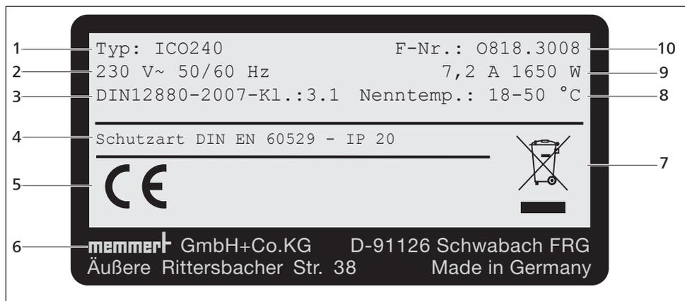
Fig. 5 Placa de identificación (ejemplo)
