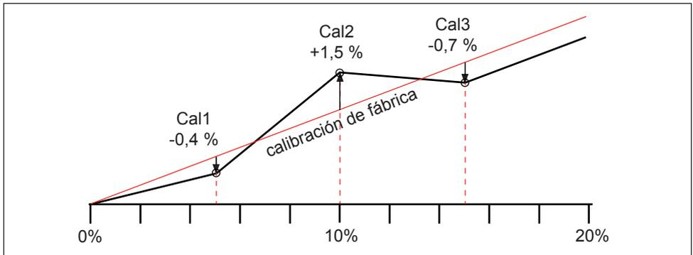
Fig. 32 Calibración de CO<sub>2</sub> (ejemplo)
