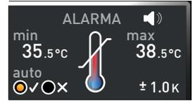
La reacción del sistema de vigilancia de la temperatura se muestra en el indicador de temperatura a través del valor de temperatura real resaltado sobre un fondo rojo y un símbolo de alarma ⚠ (Fig. 19). Debajo se indica el tipo de control de temperatura que se ha activado (en el ejemplo TWW).
