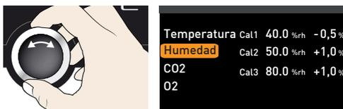
3. Presione la tecla de confirmación varias veces hasta que se resalte el punto de compensación Cal2.
