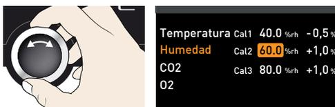
5. Guarde la configuración presionando la tecla de confirmación. A continuación se resalta el valor de compensación correspondiente de forma automática.
