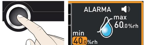
4. Ajuste el límite inferior de alarma deseado con el botón giratorio, en el ejemplo de la derecha 50 % rh.
