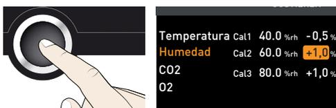
6. Ajuste el valor de compensación a 0,0 % y guarde la configuración presionando la tecla de confirmación.
