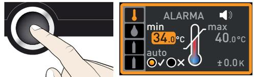
3. Ajuste el límite inferior de alarma deseado con el botón giratorio, en el ejemplo de la derecha 35.5°C.
