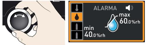
3. Acepte la selección con la tecla de confirmación. A continuación se resalta el límite inferior de la alarma de humedad de forma automática.
