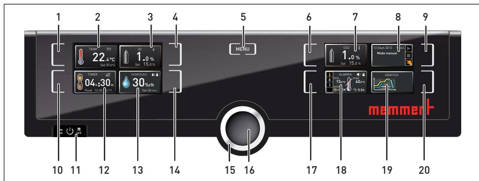
Fig. 16 ControlCOCKPIT de equipos ICO con O<sub>2</sub> y control de humedad activo en el modo de funcionamiento
