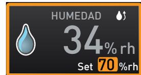
Durante el calentamiento, la velocidad de la humedad durante la regulación dinámica para aproximarse al valor de humedad de referencia, depende del punto de rocío de la temperatura de la cámara interior.
