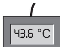
9. Ajuste en SETUP el valor de compensación de Cal2 a +1,6 K (el valor real registrado menos el valor nominal) y guarde la configuración presionando la tecla de confirmación.
