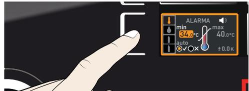
2. Acepte la selección presionando la tecla de confirmación. El ajuste mín. (protección contra temperatura inferior) se activa de forma automática.
