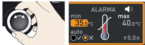
**i** El límite inferior de alarma no se puede ajustar más alto que el superior. Si no se necesita ninguna protección contra temperatura inferior, ajuste la temperatura mínima.
