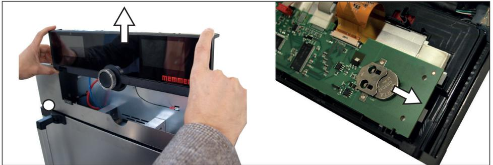
Abb. 34 Lithiumbatterie entfernen
