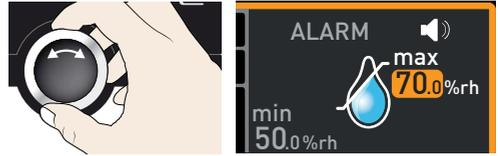
7. Zur Bestätigung Bestätigungstaste drücken und Anzeige Alarm durch Drücken der seitlichen Aktivierungstaste verlassen. Die Feuchteüberwachung ist nun aktiv.
