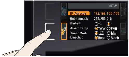
2. Auswahl mit der Bestätigungstaste bestätigen. Es wird automatisch der erste Ziffernblock der IP-Adresse markiert.
