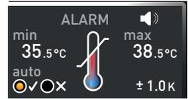
Wenn eine Temperaturüberwachung angesprochen hat, wird dies in der Temperaturanzeige angezeigt: durch die rot hinterlegte Isttemperatur und ein Alarmsymbol
