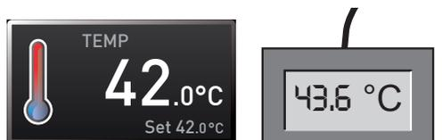
9. Abgleichkorrekturwert zu Cal2 im SETUP auf +1,6 K (gemessener Referenzwert minus angezeigter Wert) einstellen und Einstellung durch Drücken der Bestätigungstaste speichern.
