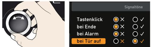
2. Auswahl durch Drücken der Bestätigungstaste bestätigen. Es werden automatisch die Einstellungsmöglichkeiten markiert.
