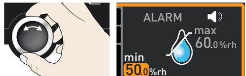
5. Auswahl mit der Bestätigungstaste bestätigen. Es wird automatisch der obere Feuchtealarmgrenzwert markiert.
