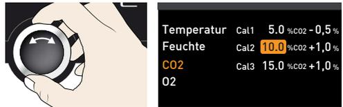
5. Einstellung durch Drücken der Bestätigungstaste speichern. Es wird automatisch der dazugehörige Abgleichkorrekturwert markiert.
