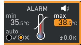
6. Oberen Alarmgrenzwert durch Drücken der Bestätigungstaste übernehmen. Es wird automatisch die Einstellung des automatischen Temperaturwächters (ASF) aktiviert (auto).
