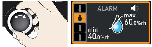
3. Auswahl mit der Bestätigungstaste bestätigen. Es wird automatisch der untere Feuchtealarmgrenzwert markiert.
