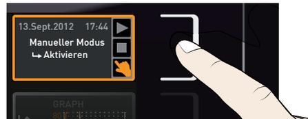
2. Drehknopf drehen, bis das Startsymbol ▶ markiert ist. Es wird das aktuell zur Verfügung stehende Programm angezeigt, in diesem Beispiel Steri 180.
