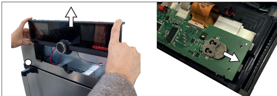
Fig. 33 Rimozione della batteria al litio
