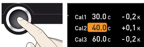
3. Con l'ausilio della manopola impostare la temperatura di compensazione Cal2 a 42 °C.
